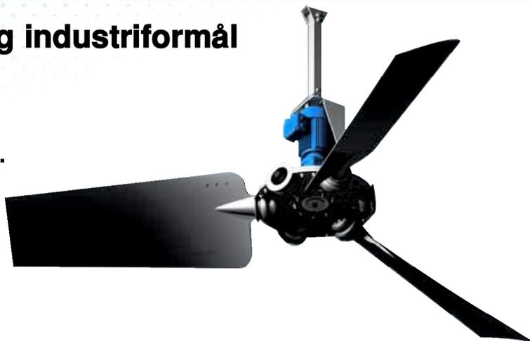
Bruk av blandevifte som temperaturutjevner er økonomisk ved temperaturdifferanse på 4-5 °C mellom gulv og tak. Under optimale forhold kan energimengden til oppvarming reduseres med 30%. I tillegg til reduserte fyringsutgifter vinterstid vil viften også egne seg til å gi et svalere arbeidsmiljø sommerstid. Dette er særlig aktuelt for fjøs med naturlig ventilasjon og i lokaler med stor solinnstråling eller varmeproduserende maskiner.
