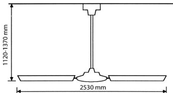
Relivent 3000 luftblandevifte leveres standard med frekvensstyring for manuell innstilling av ønsket viftekapasitet. Flere vifter kan reguleres parallelt sammen. Relivent 3000 luftblandevifte kan også automatisk hastighetsreguleres.
